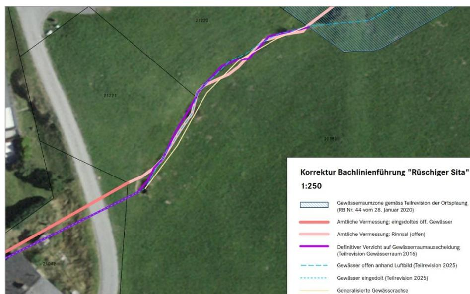
Abb. 5 Arbeitsplan- Korrektur des Bachverlaufs und Erarbeitung der generalisierten Gewässerachse (vgl. Anhang 2)
